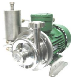
Взрывозащитное исполнение с двойным торцовым уплотнением
