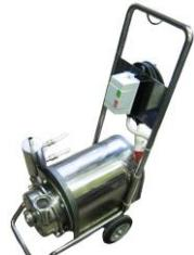
Исполнение на тележке с пускателем
