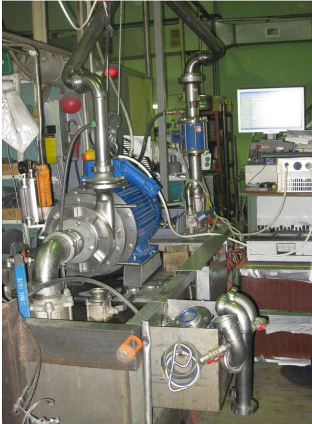
Стендовые испытания ламинарных насосов ОНЛ
